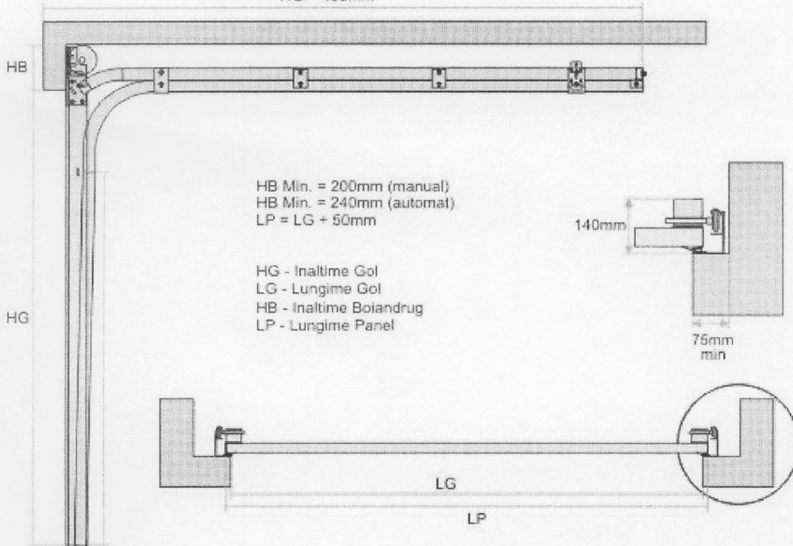
usi cu montajul arcului de torsiune in fata ce necesita un boiandrug de 70mm
